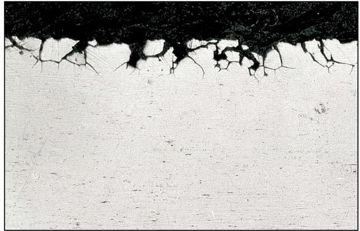
上記顕微鏡写真は研磨された後強酸でエッチングされたステンレスのサンプルを示す。網状の黒線は粒子そのものよりもはるかに耐食性が低い粒間への強力な化学薬品の侵攻と一致している。
