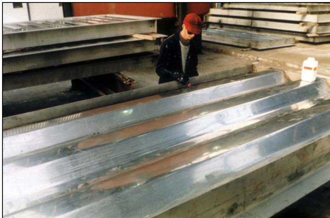
海上プラットフォームの甲板に建設中の 台形耐衝撃壁
