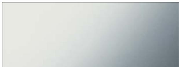
2R 研磨ロールによる冷延後に無酸素大気状態で光輝焼鈍を行なうことで物体を明確に映し出す反射性の高い仕上げが得られる。
