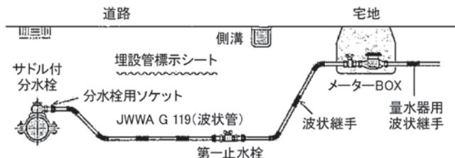
図2 ステンレス配管モデルシステム概念図<sup>2)</sup>
