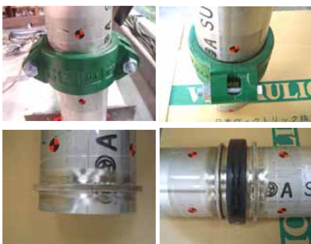
写真 - 7 回収したハウジング継手
