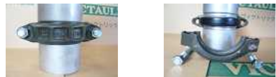
写真 10 回収したハウジング継手
