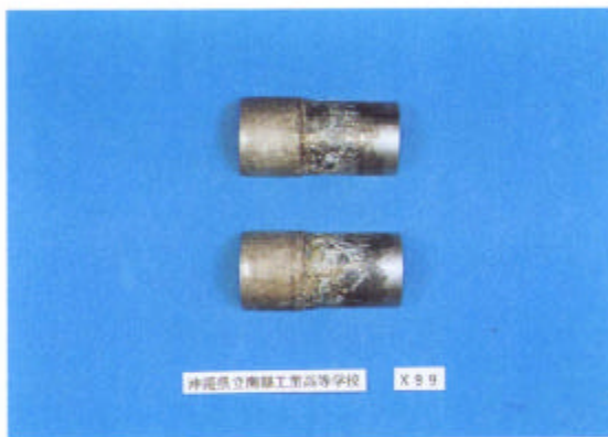
(2) はんだ式継手 (酸洗後)
