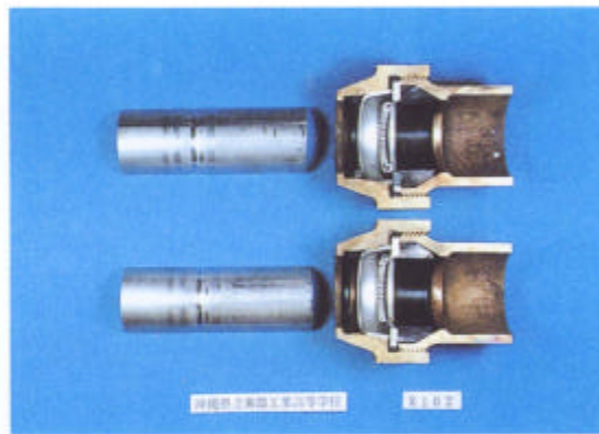
(5) 可とう式(A)継手 (酸洗後)
