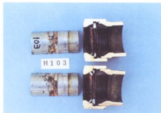
(6) 可とう式(B)継手 (酸洗後)
