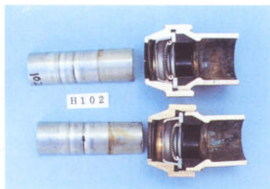
(5) 可とう式(A)継手 (酸洗後)
