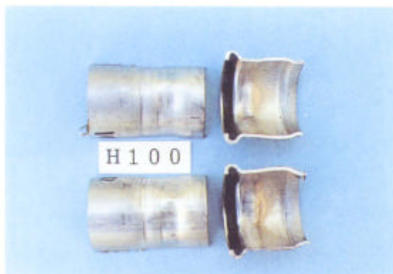
(3) プレス式継手 (酸洗後)
