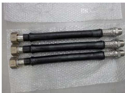
写真 8 引張試験後状況 (25Su)
