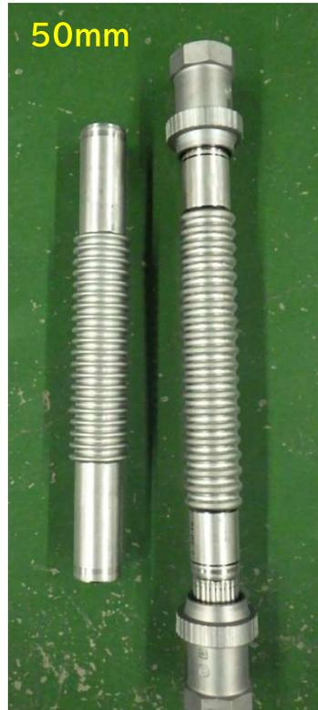
写真2 波状部（左：試験前 右：試験後）
