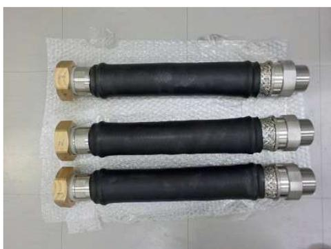
写真 14 引張試験後状況 (50Su)
