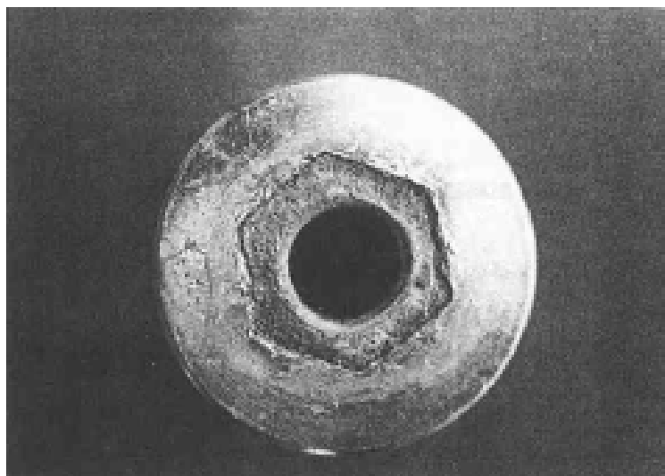
図 1.3-4 SUS316L のすきま腐食（日本金属工業提供）
