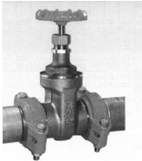
図 3.8-5 ハウジング形（管に凹溝を加工して抜け止めとし、ゴム製リングにてシールする形式） 2)
