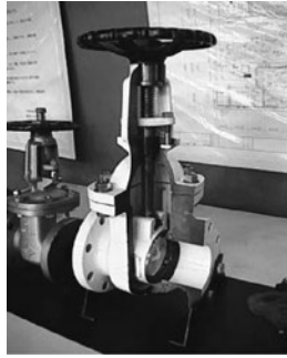
図 3.8-3 フランジ形相対するつば（鑊）状の継手を対向させ、ガスケットを挟んでボルト・ナットで接続する形式） 2)
