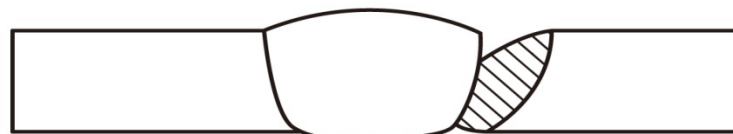
(e) HAZ 腐食 (III)
